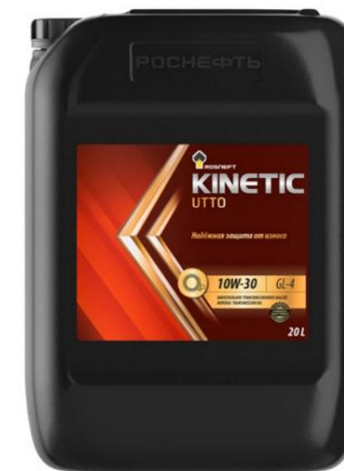
Rosneft Kinetic UTTO 10W-30 — всесезонное универсальное тракторное трансмиссионное масло (Universal Tractor Transmission Oil). Изготавливается из высококачественных гидроочищенных минеральных базовых масел и пакета присадок. Улучшенные вязкостно-температурные характеристики обеспечивают легкий запуск и надежную работу трактора при температуре окружающего воздуха до -25 °C.
